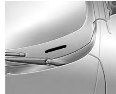
A placa com o número de identificação do veículo fica no canto dianteiro do painel de instrumentos, no lado do motorista. Ela pode ser vista de fora, através do para-brisa.
