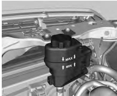
O nível do fluido da direção hidráulica precisa estar entre as marcas **MIN** e **MAX**.
