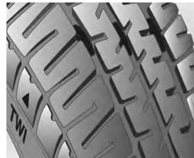
Os pneus também deverão ser substituídos quando a profundidade da banda de rodagem estiver desgastada até próximo do indicador de desgaste do pneu. A imagem mostra onde a profundidade da banda de rodagem pode ser encontrada.
