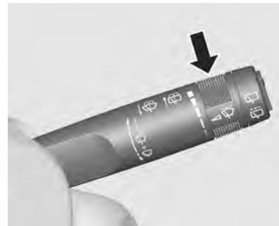
Com a alavanca do limpador na posição
