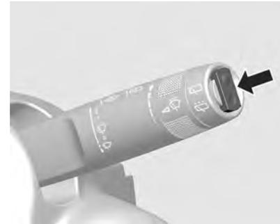
Para operar o limpador do vidro traseiro, com a ignição na posição **1** e/ou **2**.
