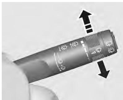
Para operar os limpadores do para-brisa, com a ignição na posição **1** e/ou **2**. Para operá-los de maneira intermitente ou continuamente, mova a alavanca do limpador/lavador do para-brisa para cima. Para operá-los manualmente, mova a alavanca para baixo. Nesta posição, a alavanca possui um retorno automático.
