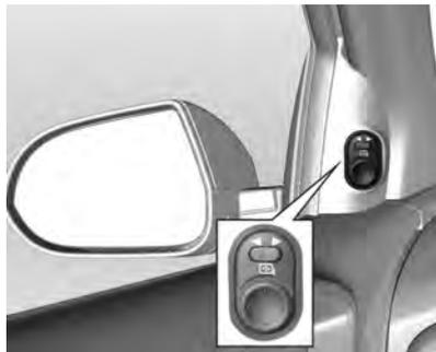
Selecione o espelho externo esquerdo ou direito com o interruptor do seletor e ajuste-o com o interruptor de quatro posições.
