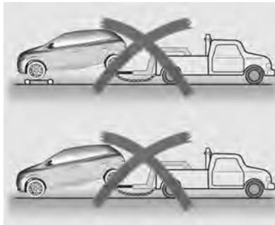
Não é adequado rebocar em duas rodas, isto poderá causar danos ao veículo.
