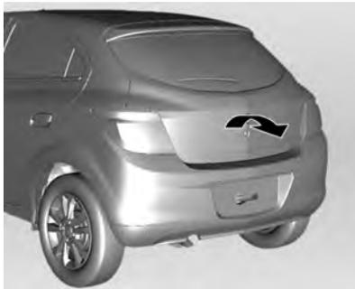
Para destravar e abrir a tampa do compartimento de carga, insira a chave na fechadura e gire no sentido horário ou pressione o botão
