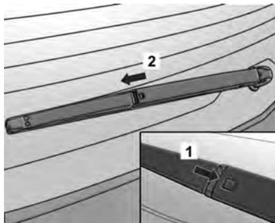
Levante a alavanca do limpador. Pressione a aba de travamento (seta 1) e puxe a palheta para a esquerda para removê-la (seta 2).
