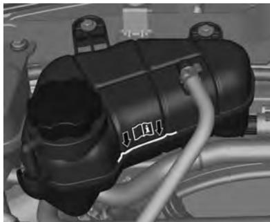
Raramente ocorre perda em um sistema de arrefecimento de circuito fechado. Portanto, raramente é necessário completar o nível, mas
