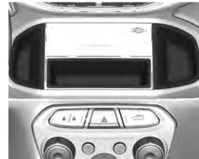
Existem três porta-objetos no painel de instrumentos para veículos sem sistema de conforto e conveniência. Eles podem ser utilizados para guardar pequenos objetos.
