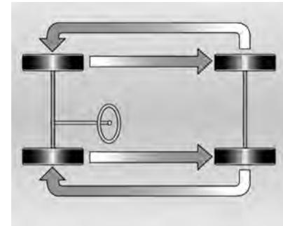
Forças diferentes nos pneus dianteiros e traseiros fazem com que eles se desgastem de forma diferente, dependendo de vários fatores, como a superfície da pista, a forma de condução, o alinhamento da suspensão, o balanceamento das rodas, a pressão dos pneus etc.
