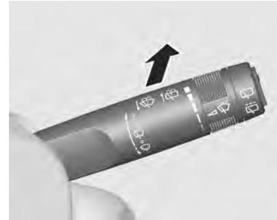
Empurre a alavanca em direção ao painel de instrumentos.
