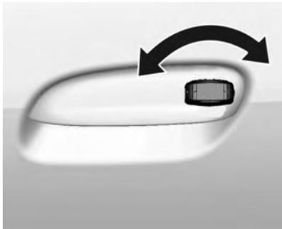
Para veículo equipado com trava elétrica das portas, gire a chave no sentido anti-horário. Todas as portas serão travadas. Para veículo sem
