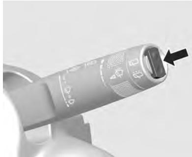
Para operar o limpador do vidro traseiro, pressione o interruptor na extremidade da alavanca.
