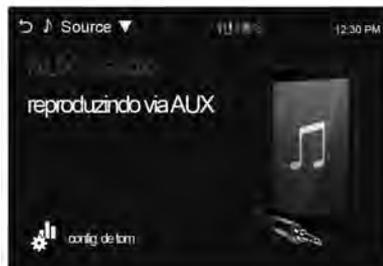
**Nota:** Se o dispositivo auxiliar já está conectado, pressione [HOME (ícone)] > [áudio] > [Fonte ▼] > [AUX] para reproduzir músicas do dispositivo auxiliar.
