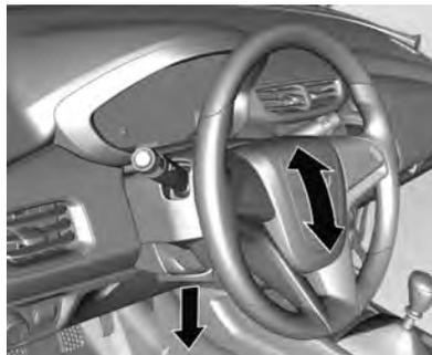
Destrave a alavanca, ajuste a altura do volante e trave-o novamente, e assegure-se de que esteja totalmente travada.
