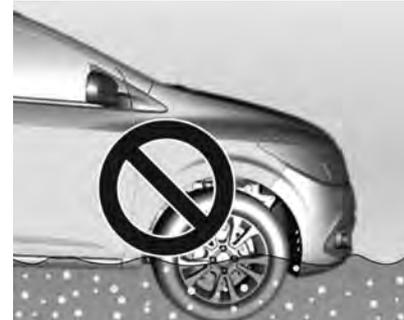
Dirija em baixa velocidade através de qualquer área alagada e certifique-se de que o limite de água não exceda a altura do centro da roda.
