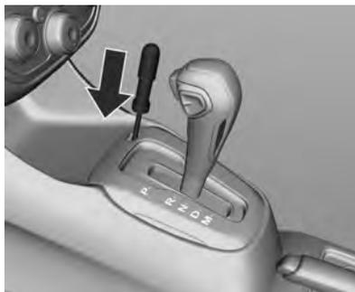
3. Insira uma chave de fenda no orifício até que a alavanca destrave, mova a alavanca seletora da posição **P** para a posição **N**.
